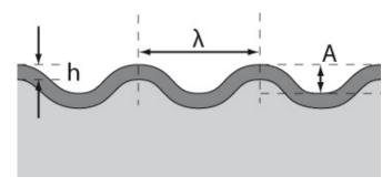
Strukturierung von Oberflächen durch Faltenbildung h = Dicke der Filmschicht
