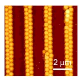
Die faltenstrukturierten Oberflächen können als Template zur Anordnung von kolloidalen Partikeln dienen.
