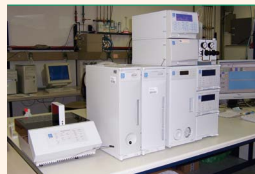
Abb. rechts: Ionenchromatographie: Ionare Spezies wie Fluorid, Bromid, Chlorid, Nitrit, Nitrat, ortho-Phosphat und Sulfat werden in wässrigen Proben mittels Ionenaustauschchromatographie und anschließender Leitfähigkeitsdetektion mit Suppressionstechnik oder UV-Detektion analysiert.
