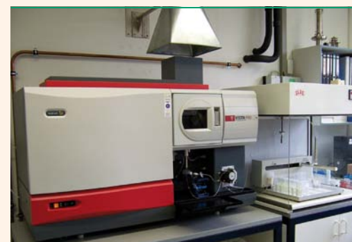
ICP-OES: In wässrigen Lösungen können ca. 70 Elemente vom unteren Prozentbereich bis in den \mu\text{g/l} -Bereich quantitativ bestimmt werden.
