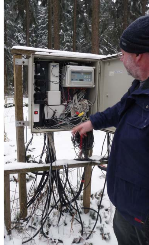
Gerhard Müller erklärt die Funktion eines Schaltkastens mit Datenloggern am Coulissenhieb II (Exkursion im Februar 2011)
