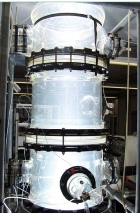
Abb. 3: Partikelneubildung im Labor: Durch Oxidation natürlicher organischer Verbindungen entsteht unter kontrollierten Bedingungen eine Feinstaubwolke. Foto: Johannes Ofner
