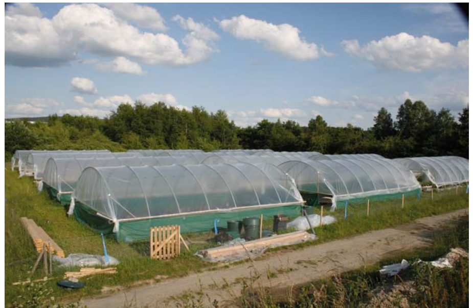
Abb. 4: Überblick über das EVENT 3 Experiment im Ökologisch-Botanischen Garten. Es besteht aus insgesamt 12 Folientunnels, in denen jede der vier Klimabehandlungen (Kontrolle; Dürre; Erwärmung; Dürre kombiniert mit Erwärmung) dreimal wiederholt wird.
