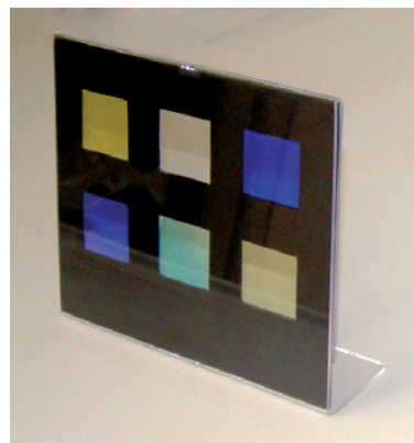
Gefärbte und farblose Folien aus Spinnenseide. Foto: Lehrstuhl für Biomaterialien
