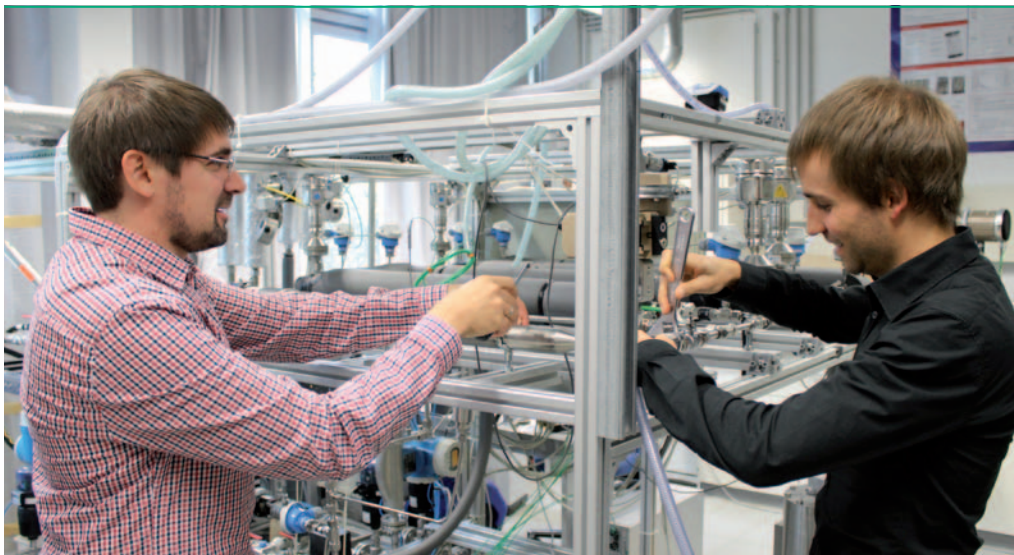
■ Dr.-Ing. Florian Heberle und Dr.-Ing. Markus Preißinger (v.l.) an einem Teststand zur Messung von Wärmeübergangskoeffizienten für die Verdampfung und Kondensation in geothermischen Kraftwerken (Foto: Chr. Wißler).
