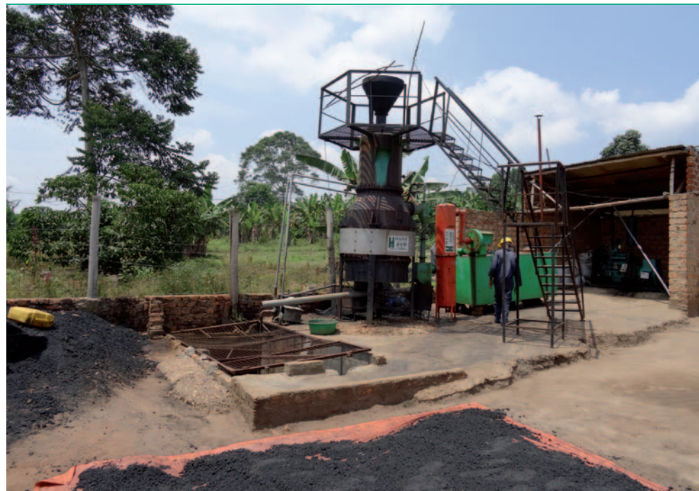
Abb. 4: 32 kW-Holzvergaser in Tiribogo, Uganda (Foto: F. Schwarz).
