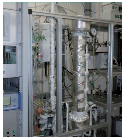
Abb. 3: Laboranlage am Lehrstuhl für Chemische Verfahrenstechnik zur Erzeugung von Dieselöl aus Kohlendioxid und Wasserstoff.
