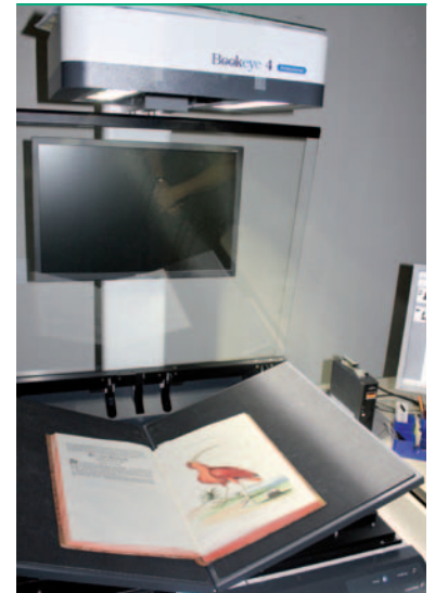
Abb. 6: Ein leistungsstarker Scanner der Universitätsbibliothek Bayreuth ermöglicht eine hochauflösende Digitalisierung von Buchseiten, wie hier aus einem vogelkundlichen Werk aus dem 19. Jh. (Foto: Christian Wißler).
