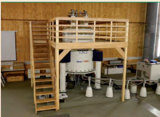
Abb. 5: Blick in die Halle für NMR-Spektroskopie des Lehrstuhls für Biopolymere; in der Mitte das neue 1 GHz-Gerät. Mit dieser Forschungstechnologie kann man beobachten, wie bestimmte Atomkerne eines Proteins in einem Magnetfeld frequenzabhängig mit elektromagnetischen Wellen in Wechselwirkung treten (Foto: Peter Kolb).
