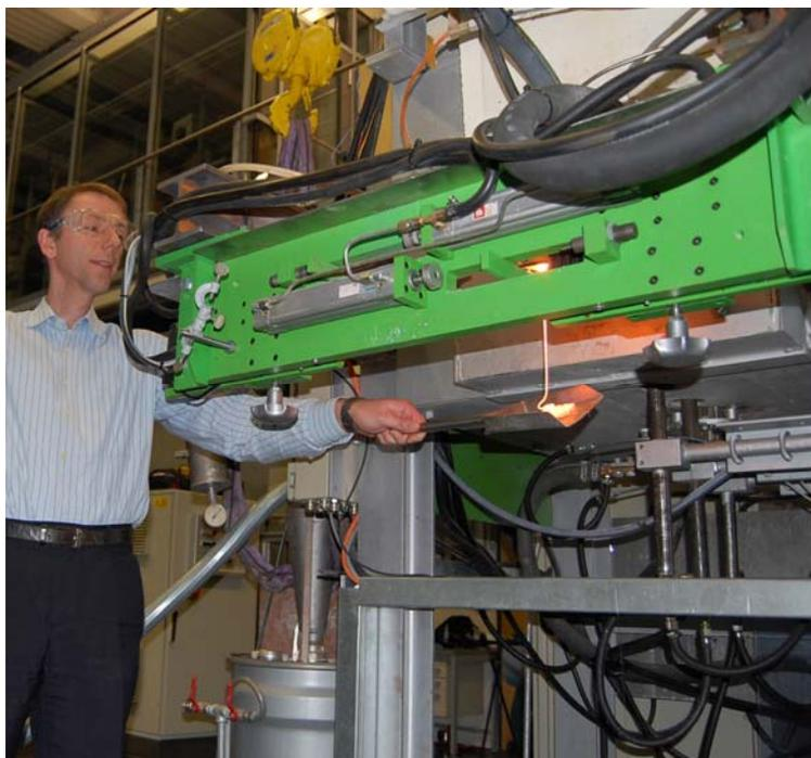
Der Forschungsverbund Forglas verfügt auch über einen Mini-Melter, mit dem Firmen den Einstieg in die Produktion spezieller Gläser testen können. Darauf wies Dr. Thorsten Gerdes hin.
