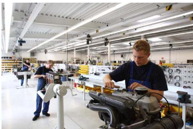
Unternehmen der Austauschteileproduktion arbeiten gebrauchte Automobilkomponenten auf und machen daraus neuwertige Ersatzteile.
