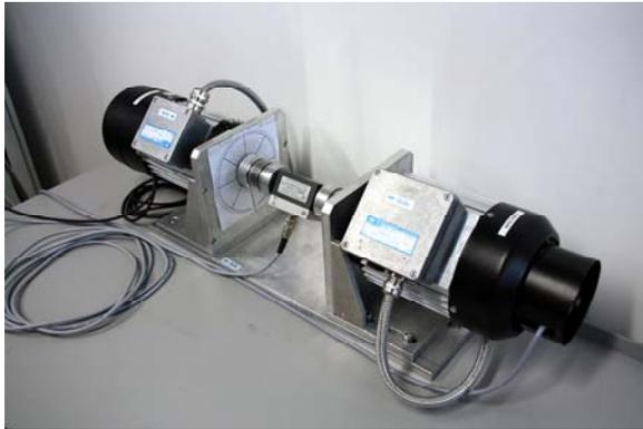
Prüfstand für Elektromotoren in der FAN.
