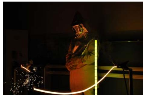
Drahtglühexperiment: Materialversagen durch Starkstrom / die Glühfarben von Reineisen
