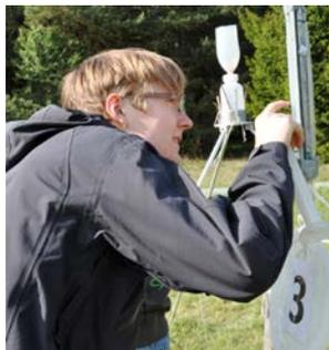
Während eines Freilandpraktikums bestimmt Friedrich Boeing an einem Lysimeter die Verdunstung des Bodens.
