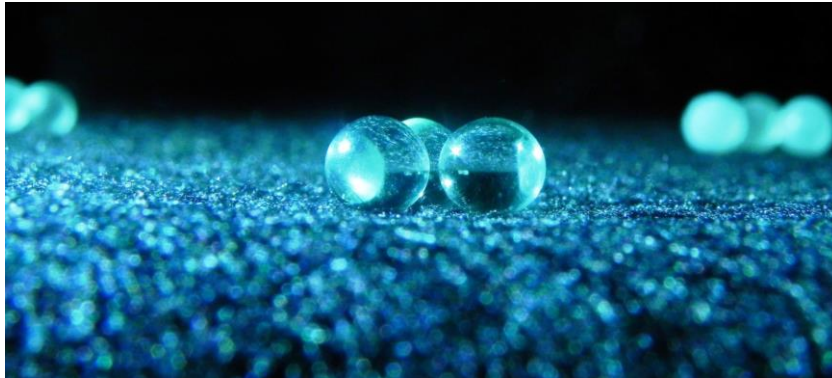
Durch Walzenpressen hergestellte Glaskugeln. Foto: Lehrstuhl für Werkstoffverarbeitung, Universität Bayreuth.
