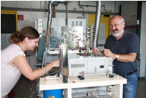
Julienne Schiebold und Prof. Dr. Gerhard Gebauer bei Laborarbeiten an einem Massenspektrometer zur Bestimmung von Isotopenhäufigkeiten. Foto: Christian Wißler.
