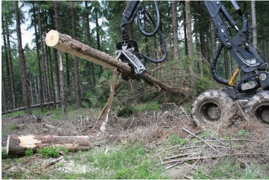
Holzerntemaschine, engl. Harvester . Foto: Gregor Aas.
