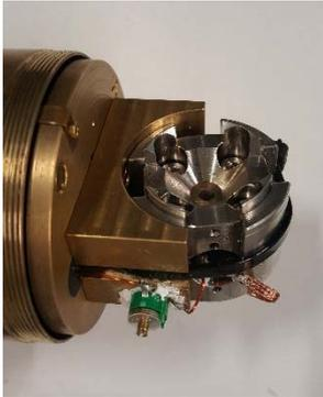
Blick in die offene Hälfte einer Diamantstempelzelle.
