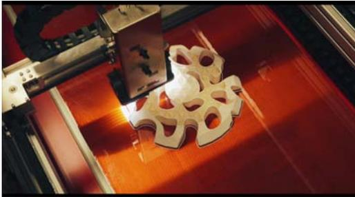
Additive Fertigung mittels Materialextrusion eines Großbauteils.
