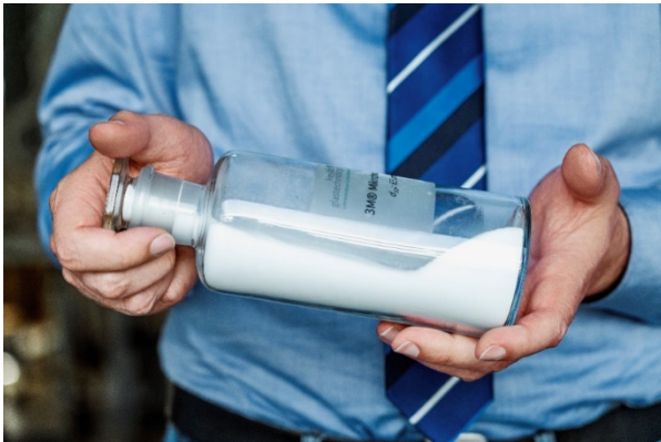
Fein wie Puder rieseln die Glaskügelchen, die den Putz zum innovativen Dämmmaterial machen. Foto: Deutscher Zukunftspreis / Ansgar Pudenz
