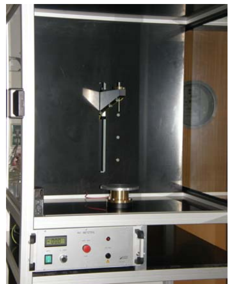
Elektrospinning-Anlage: Eigenentwicklung des Lehrstuhls für Werkstoffverarbeitung
