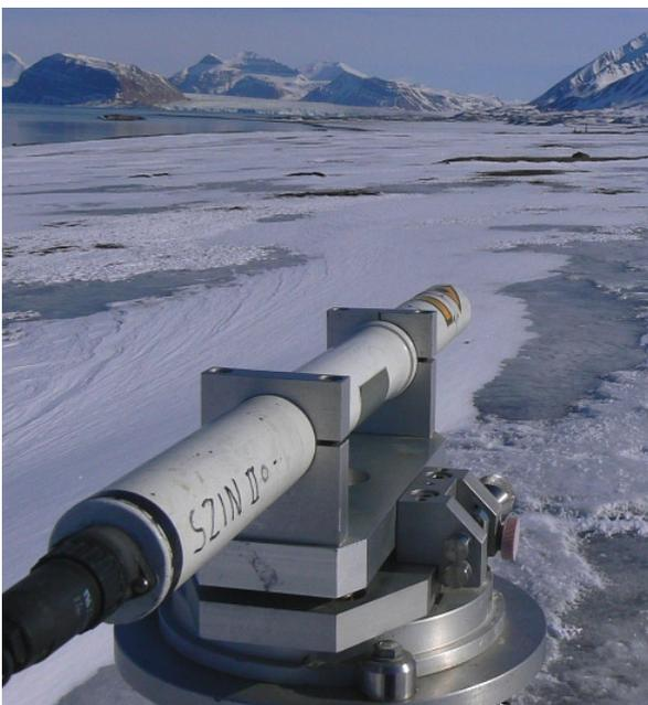
Laser-Szintillometer am Anfang einer rund 100 m langen Messstrecke in 1,5 Metern über dem Boden
