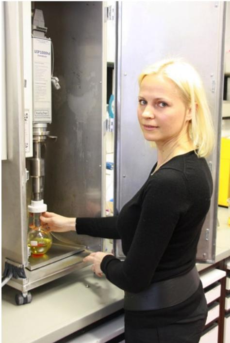
Dr. Daria Andreeva zeigt, wie feste Partikel in einer wässrigen Lösung einer Ultraschall-Behandlung ausgesetzt werden. Dabei kommt ein Ultraschallprozessor zum Einsatz, der mit einer Frequenz von 20 kHz und einer maximalen Leistung von 1000 W arbeitet.
