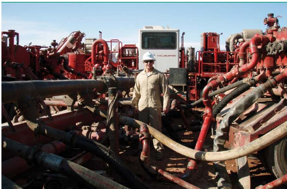
Das Hydraulic Fracturing – oder kurz: Fracking – ist derzeit ein weltweit diskutiertes Verfahren der Schiefergasgewinnung. Dabei wird eine besondere Flüssigkeit „Fracfluid“ durch ein Bohrloch in tiefe Gesteinsschichten eingepresst. (Foto: Joshua Doubek / CC-BY-SA-3.0)
